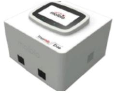
Fully Automatic Real Time Quantitative PCR Analyzer, dengan sistem tiga panjang gelombang, dapat menjalankan 20 – 24 test dalam waktu 8 jam. Amplifikasi mutu, deteksi dan pelaporan
